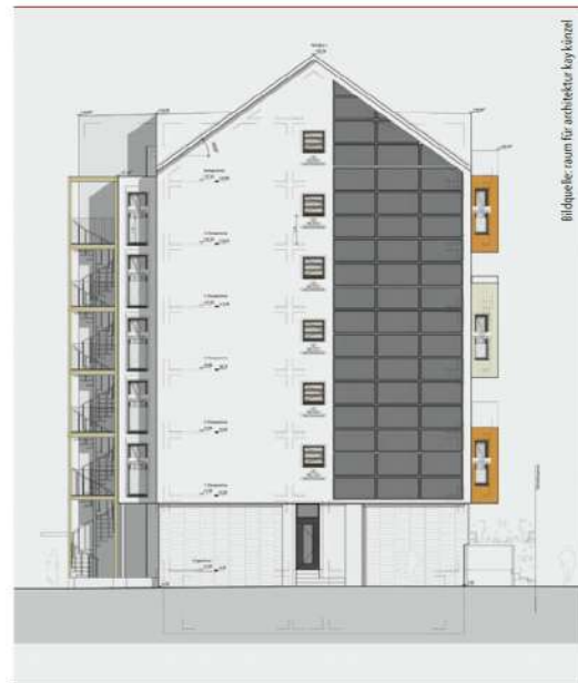
Die Gebäudehülle wurde mit vorgefertigten Holzrahmenelementen gedämmt. Auf der ufer Vorderseite bekam jede Wohnung einen neuen Erker vorgehängt, auf der Rückseite wurden die HRB-Elemente im Abstand von 1,80 m vor die Bestandswand montiert.
